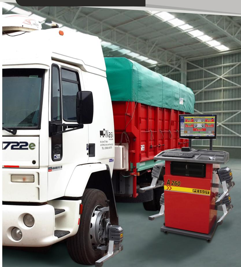
» Alineadora computarizada de ruedas con transmisión de datos inalámbrica de 2,4 Ghz y sensores infrarrojos de medición CMOS de alta resolución.
